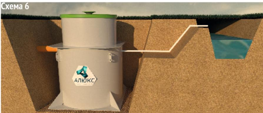
Вариант принудительного отведения очищенной воды в дренажную/придорожную канаву, на открытый грунт применяется в грунтах с низкой проницаемостью - глина/суглинок.
