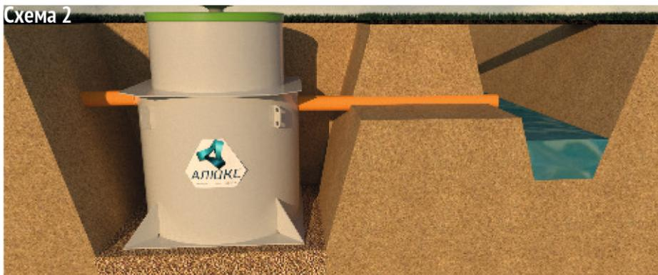
Вариант самотечного отведения очищенной воды при помощи дренажной канавы применяется при любых типах грунта.
