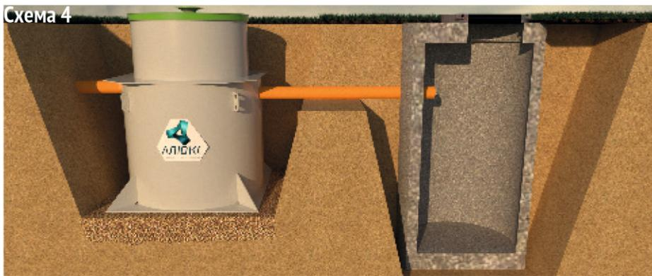
Вариант самотечного отведения очищенной воды при помощи дренажного колодца применяется в гигроскопичных грунтах с круглогодичным низким уровнем грунтовых вод.
