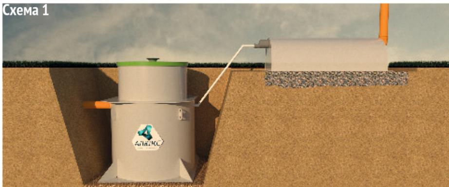
Вариант принудительного отведения очищенной воды выше уровня грунта применяется при высоком уровне грунтовых вод в отсутствии отводящих дренажных каналов. Процесс поглощения воды происходит по верхнему слою грунта.
