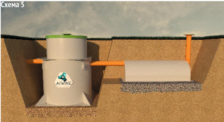
Вариант самотечного отведения очищенной воды при помощи дренажных тоннелей применяется в гигроскопичных грунтах с круглогодичным низким уровнем грунтовых вод.
