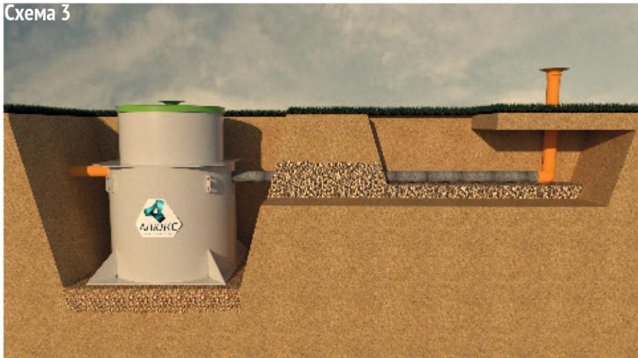
Вариант самотечного отведения очищенной воды при помощи дренажной трубы применяется в гигроскопичных грунтах с круглогодичным низким уровнем грунтовых вод.
